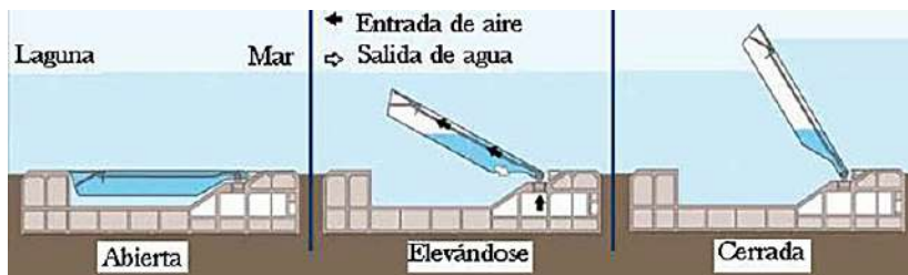
Рис. 2. Барьерная система MOSE
