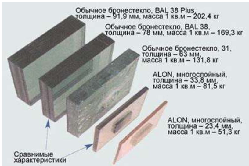
Рис. 5. Сравнение характеристик бронестекла и прозрачного алюминия [9]
